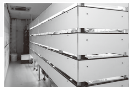
本社内屋内に設置された植物工場実験プラント「水の野菜Lab」。
