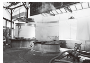
大きな釜で酒米を蒸す。水は丹沢の伏流水を井戸から汲み上げています。
