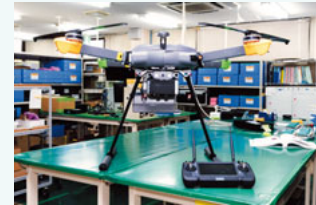
測量用の大型ドローン。ドローンの真下についているユニットで測量を行う。
