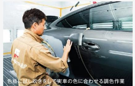
色板に試し吹きをして実車の色に合わせる調色作業
