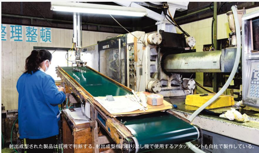
射出成型された製品は目視で判断する。射出成型機の取り出し機で使用するアタッチメントも自社で製作している。
